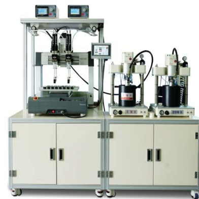
【利用高压泵的双液容积式螺杆泵点胶系统】
